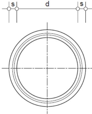
Die Wandungen der Sicker- und Brunnenringe bestehen aus haufwerksporigem Beton.
